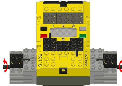
Abbildung 11: Anschließen der Motoren für die richtige Drehrichtung
