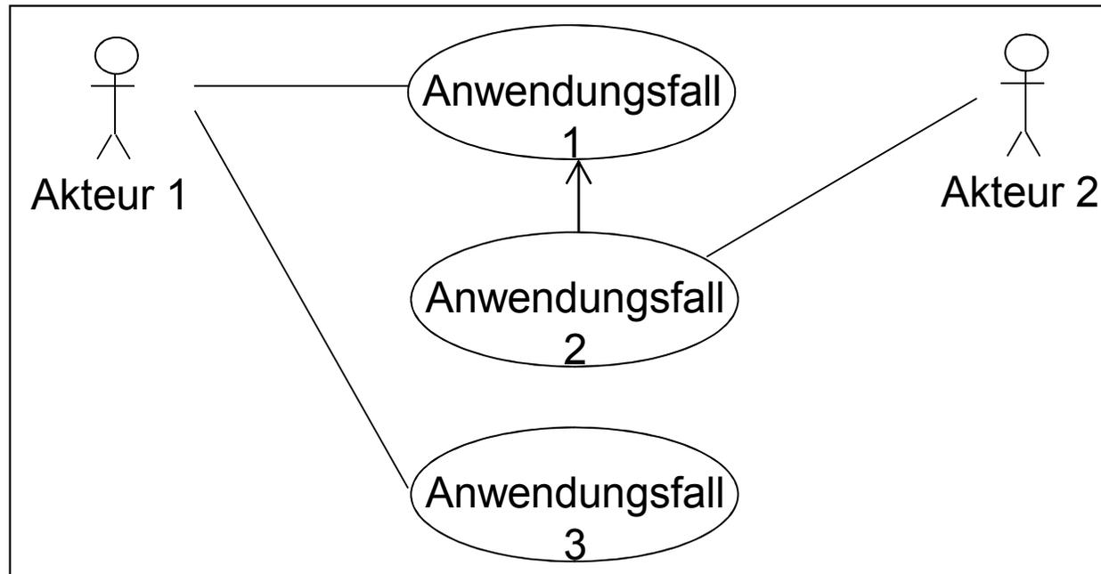
Ein Use Case (Anwendungsfalldiagramm) enthält eine Menge von Anwendungsfällen, die durch einzelne Ellipsen dargestellt werden, und eine Menge von Akteuren, die die daran beteiligt sind. Die Anwendungsfälle sind durch Linien mit den beteiligten Akteuren verbunden. Ein Rahmen um die Anwendungsfälle sind symbolisiert die Systemgrenzen.
