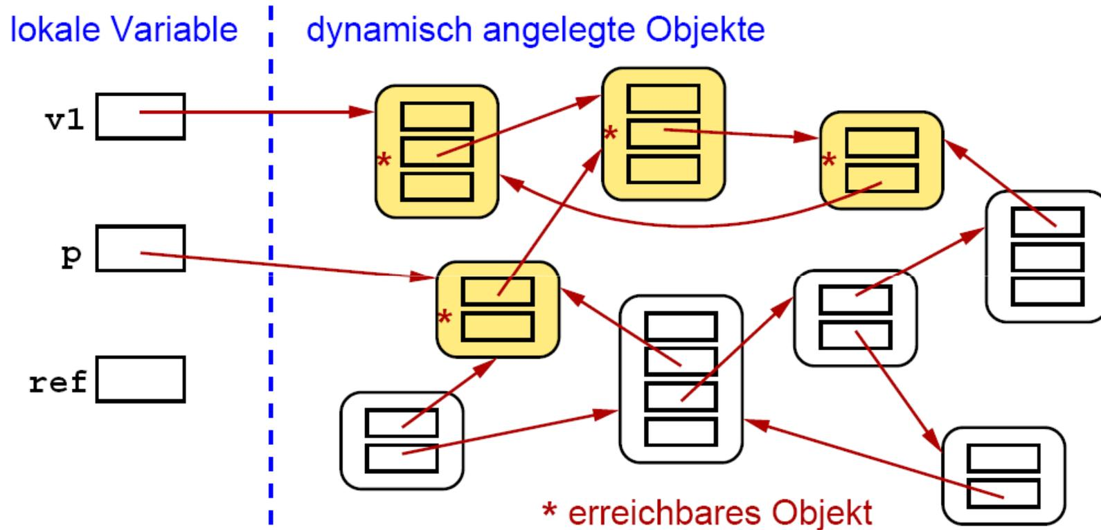
Wenn `ref` ungültig (oder mit `null` belegt) wird, markiert der *Garbage Collector* alle erreichbaren Objekte. Die unmarkierten werden dann gelöscht.
